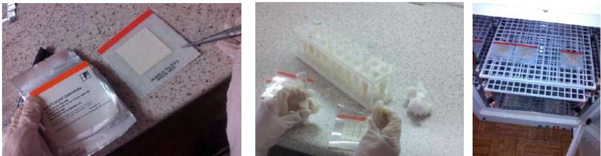
Рисунок 2.5 – Розпаковка, засів проб води та інкубація діагностичних тест-пластин (на прикладі RIDA COUNT-Salmonella)
