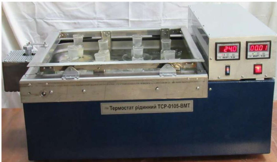
Рисунок 3 – Світлина спеціально сконструйованого і виготовленого термостату для досліджень метаногенезу
