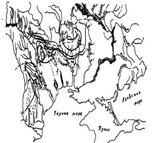
Рисунок 2 – Карта изолиний продолжительности притока воды со склонов в русловую сеть в период весеннего половодья T_0 ,
